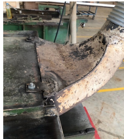
รูปที่ 2 สภาพตัวอย่างก่อนปรับปรุงของอุปกรณ์เชื่อมต่อสำหรับการดูดฝุ่นของเครื่องไสขนาด
