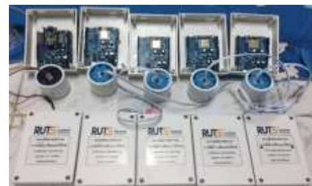
รูปที่ 10 ภาคประมวลผล (ภาคส่ง) ของระบบแสดงสถานะการให้น้ำเกลือแบบไร้สายที่นำเสนอ จำนวน 5 ชุด
